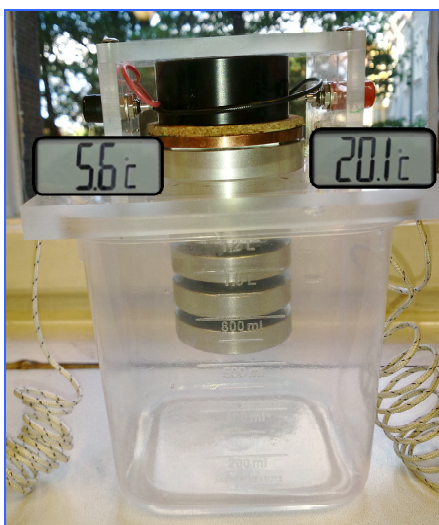
Rys.1.a. Układ do badania modułu Peltiera oraz chłodziarki peltierowskiej
