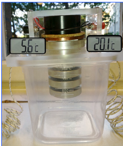
Rys.1.a. Układ do badania modułu Peltiera oraz peltierowskiej pompy ciepła.
