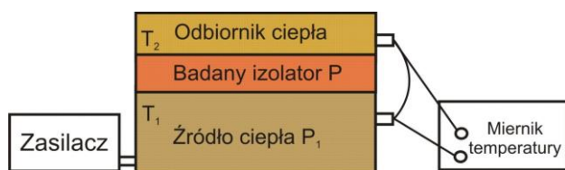
Rys.2. Schemat układu płyt do pomiaru przewodności cieplnej izolatora.
