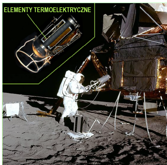
Rys.1. Fotografia z wyprawy Apollo 12 [NASA] w 1969 roku. Astronauta Alan Bean wkłada pojemnik z paliwem w postaci izotopu plutonu do radio-izotopowego generatora termoelektrycznego. W lewym górnym rogu: kapsuła z elementami termoelektrycznymi w zbliżeniu. (fotografia: commons.wikimedia.org).
