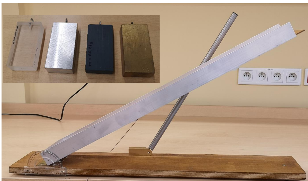
Rys 1. Model równi pochyłej z kątomierzem, badane prostopadłościany.
