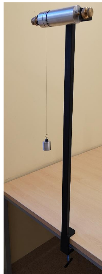
Rys.1. Układ pomiarowy – walec aluminiowy z nawiniętą nicią obciążoną odważnikiem, zestaw odważników.
