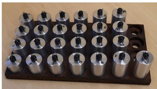
Rys.1. Układ pomiarowy – walec aluminiowy z nawiniętą nicią obciążoną odważnikiem, zestaw odważników.
